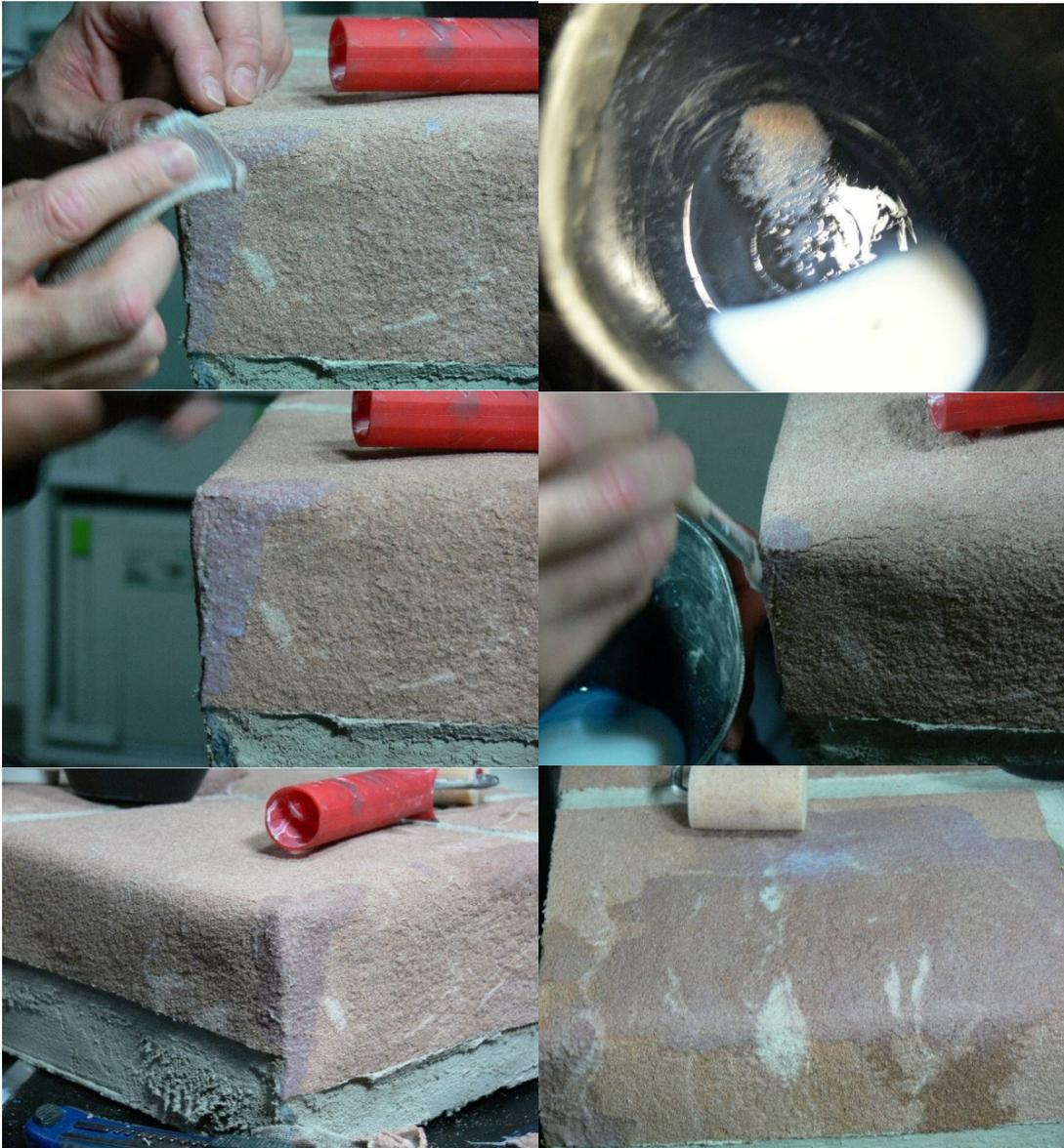
Le vitrificateur s'applique en toute fin de travaux afin de finir de stabiliser les derniers grains de quartz sur le support
